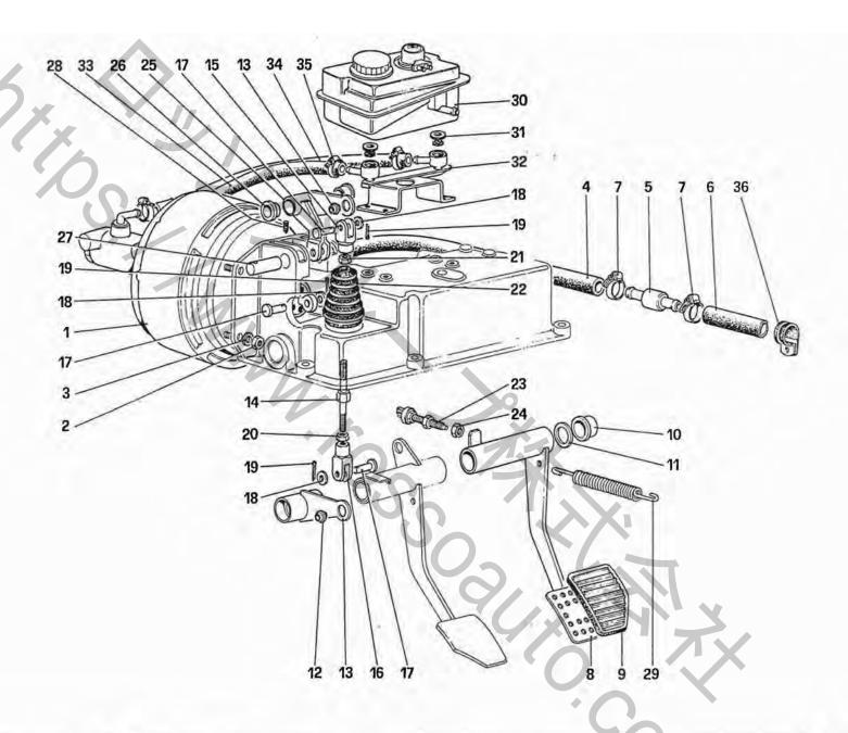
COMANDO IDRAULICO FRENI BRAKE HYDRAULIC SYSTEM TAV. 28
